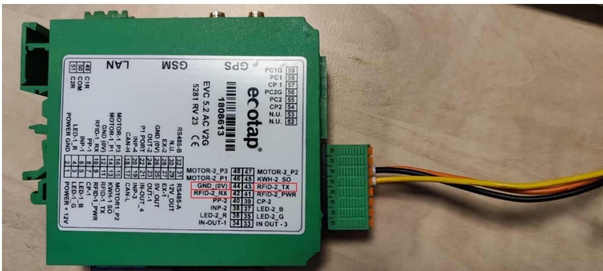
Abbildung 5.5 - Anschluss des USB-zu-TTL-Kabels an den Controller (EVC 5.x).
