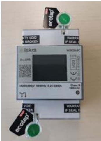
Abbildung 30. Lage der Siegel (Plombe) und Siegelaufkleber untere und ober Anschlussleiste
