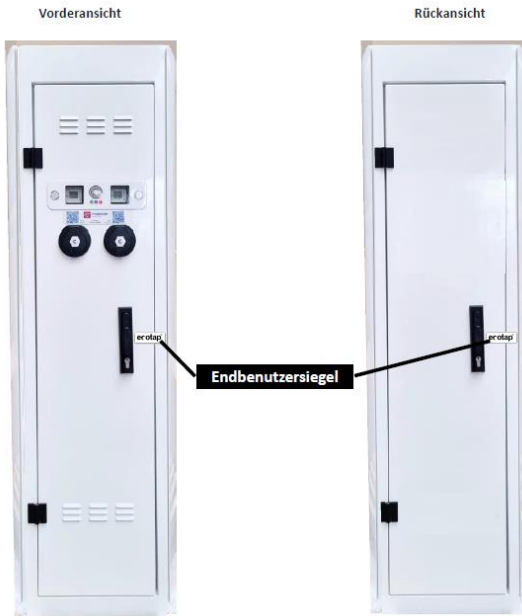
Abbildung 61. Position Endbenutzersiegel Ladesäule DUO WIDE XL
