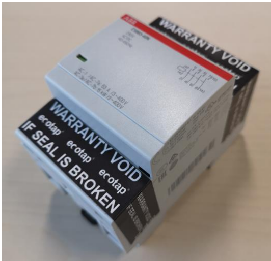
Abbildung 26. Lage des Siegelaufkleber auf dem Relais
